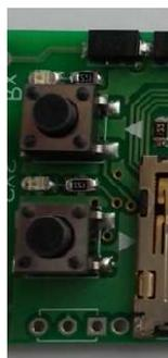
применяемого flash накопителя 2..32ГБ. Можно использовать как заранее подготовленные светодинамические программы (доступны для скачки с сайта [74led.ru](http://74led.ru), [1-leds.ru](http://1-leds.ru)) так и подготовить самостоятельно в программном обеспечении “LS Terminal”, “Jinx!”, “Light Studio Express Edition”. Для переключения программ используются две кнопки Prog + и Prog – , расположенные на плате
