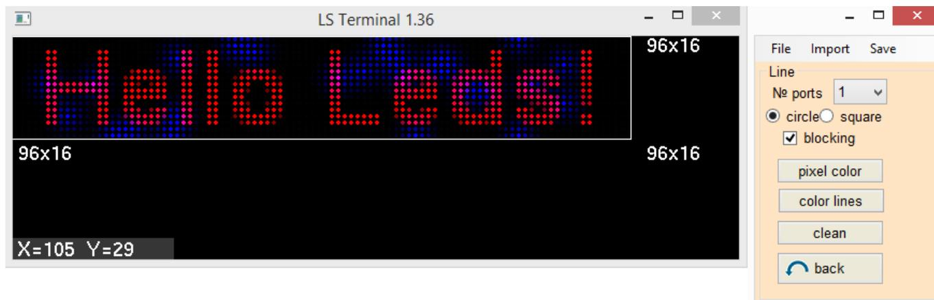
ПО LS Terminal осуществляет захват каждого кадра видео ролика и его последующую конвертацию, согласно расположению цепочки из пиксельных модулей. Цепочка пиксельных модулей заранее готовится пользователем.
